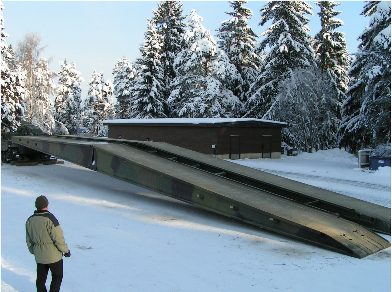
Leopard 2 L laskee 70 tonnia kantavan, 26 metrin pituisen sillan Panssariseminaarin kalustoesittelyssä.
